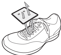
① ピンタイ(針金バンド)を靴ひもに通した後にチップの穴に通します。
